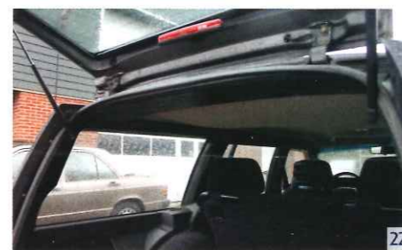
16 De 740 rijdt op dit moment alleen op LPG, waarvan de tanks weggewerkt zijn in de reservewielkuip. 17 De LPG-tanks dateren nog uit het afleverjaar van de 740. 18 Sober maar overzichtelijk. 19 Het interieur ziet er zowel voor... 20 als achterin nog netjes uit... 21 ...met hooguit een klein gaatje hier en daar in de bekleding. 22 Een hangend hemeltje betreft een standaard kwaaltje van de Volvo 740 Estate. 23 Het linker voorscherm moet al eens zijn overgespoten, afgaande op de ontbrekende 'Blackline'-striping.
