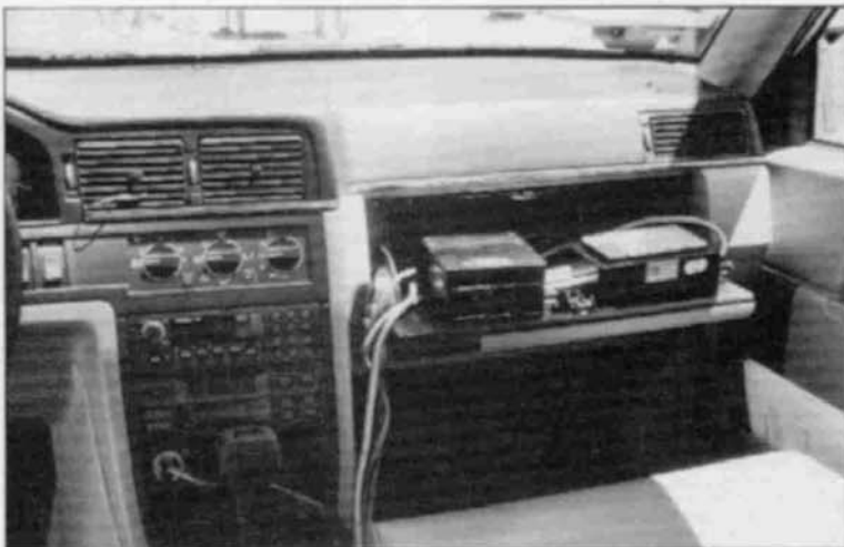
Onderweg naar de Towner Pass kon de temperatuur op verschillende plaatsen in de auto centraal worden afgelezen. De op dit moment ingeschakelde functie is de meting van de buitentemperatuur.
