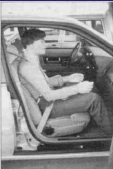
Mister Voltman, ofwel Volvo's mens-achtige pop voor temperatuuronderzoek. Hier is hij ondergebracht in een topprodukt van de Amerikaanse auto-industrie, de Lincoln Continental.
