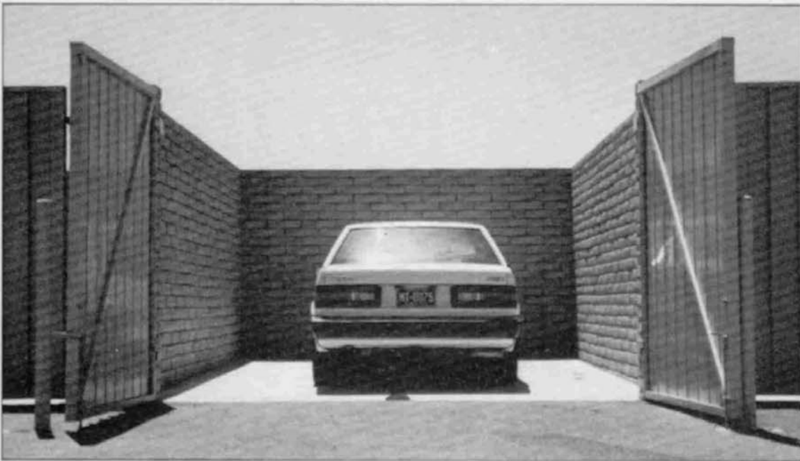
Een garage zonder dak is een uitstekend middel, om de temperatuur onder de middagzon tot ongekende hoogten op te swepen. In het interieur van deze Volvo 780 wordt het dan ruim 70°.
