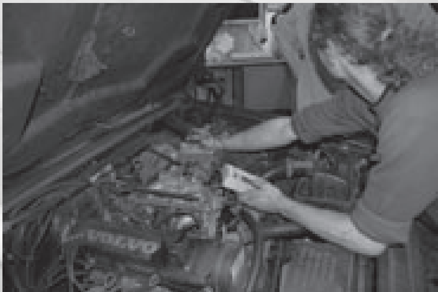
Meten aan de remolie, belangrijk voor de werking van de hohouwers.
