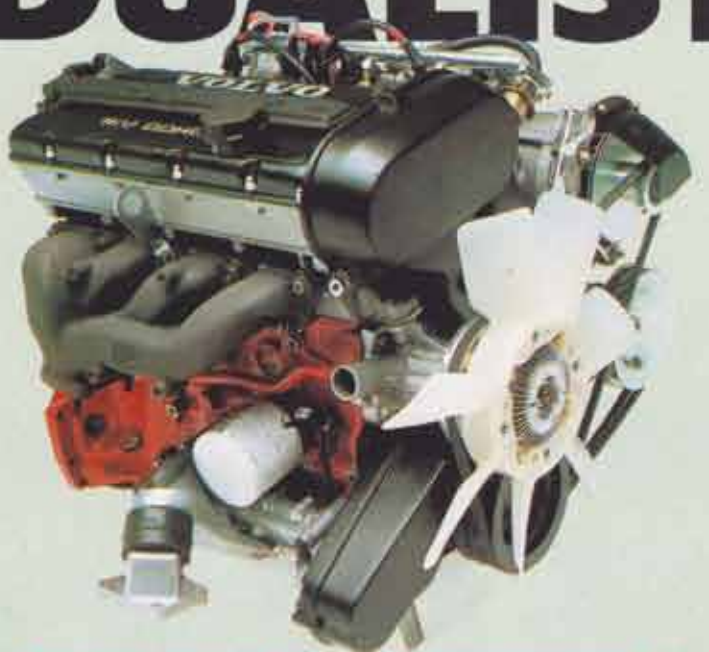
Ingewikkelde riemenwrijving. Twee nokkenassen en een oliepompe worden via een eenzijdig getande snaar aangedreven. Een andere, aan twee kanten getande riem zorgt voor de
