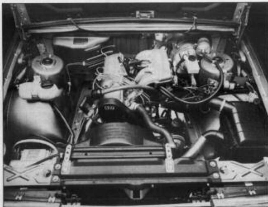
Een grote hoeveelheid onbenutte ruimte maakt de 4-cilinder gemakkelijk bereikbaar voor monteurs. De tienspaaks lichtmetalen wielen zijn extra; standaard wordt de 740 GLE geleverd met stalen wielen.
