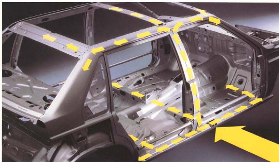
Volgens het SIPS-principe worden bij een zijdelingse botsing de krachten geabsorbeerd en verdeeld over de verschillende delen van de auto, waardoor een botsing beter kan worden opgevangen.
