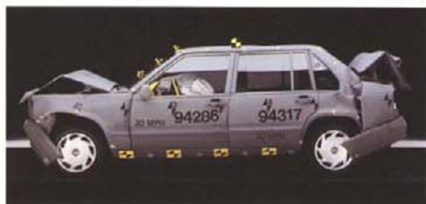
De kruiselzones aan de voor- en achterzijde vangen een groot deel van de klap op, zodat de meeste krachten al zijn opgevangen voordat ze de rest van de sterke veiligheidskooi bereiken.
