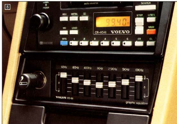
8. EQ 611 Grafische equalizer. Voor het regelen van maximaal + of - 12 dB. Door het scheiden van het frequentiegebied in 7 banden wordt een veel gevoeliger toonbalans verkregen.
